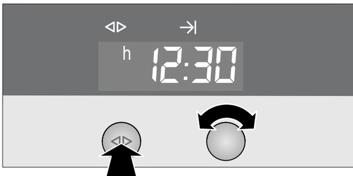
Op het tijdstip van het ingestelde gebruikseinde schakelt het apparaat automatisch uit.
